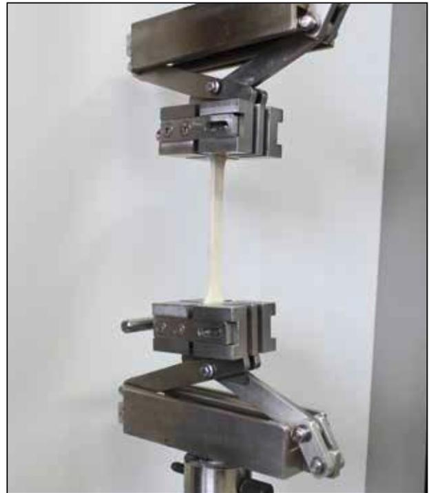
Versuchsaufbau (hier: Zeitstandszugversuch)
