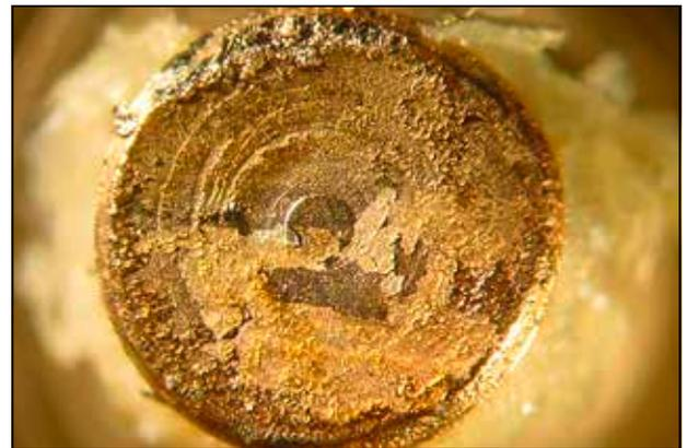
*Belagwerkstoff nach 30 min. 6x Vergrößerung, Probekörper mit Oszillationsreibspur.*
