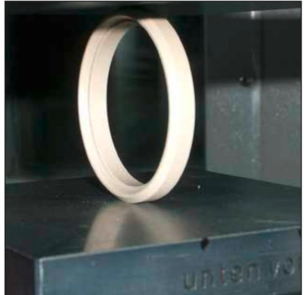
**Beispiel:** Druckprüfung an Dichtringen aus ZX-324 (axial und radial). Es wurde ermittelt, bei welcher Kraft eine bleibende Deformation auftritt bzw. bei welcher Kraft die Ringe brechen
